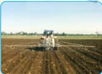
เครื่องพ่นสารเคมีติดท้ายรถแทรกเตอร์
