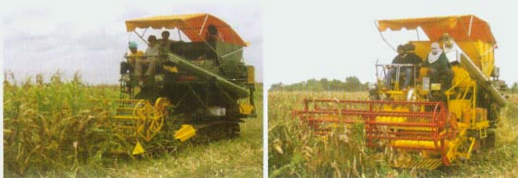
รูปที่ 12 เครื่องเกี่ยวข้าวโพดแบบใช้ราวใบมีดตัดทั้งต้นขนาด 2 และ 3 เมตร
