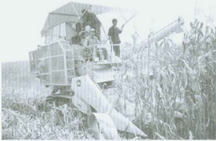
รูปที่ 17 ต้นแบบเครื่องเกี่ยวข้าวโพดแบบขับเคลื่อนด้วยตนเอง แบบใช้หัวปลัดฝัก
